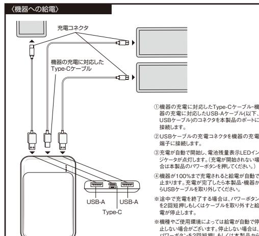
\*機器の充電に対応したType-Cケーブル・機器の充電に対応したUSB-Aケーブル以下、USBケーブルのコネクタを本製品のポートに接続します。
