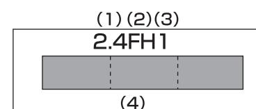
(1)2.4 : 2400MHz帯を使用する無線設備を表します。
