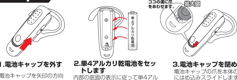
電池キャップを矢印の方向にスライドさせて電池キャップを取り外します。
